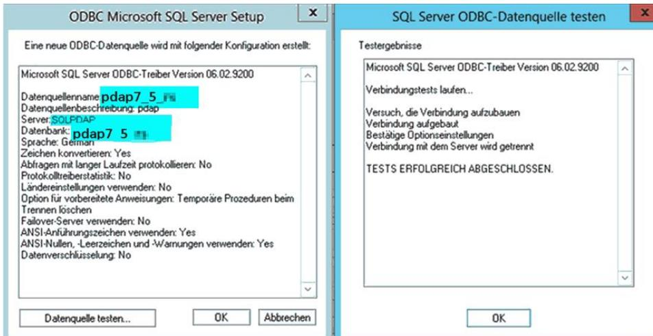
Abschließend mit ok bestätigen (Für ein Testsystem würden die Einstellungen in gleicher Weise eingerichtet werden)
